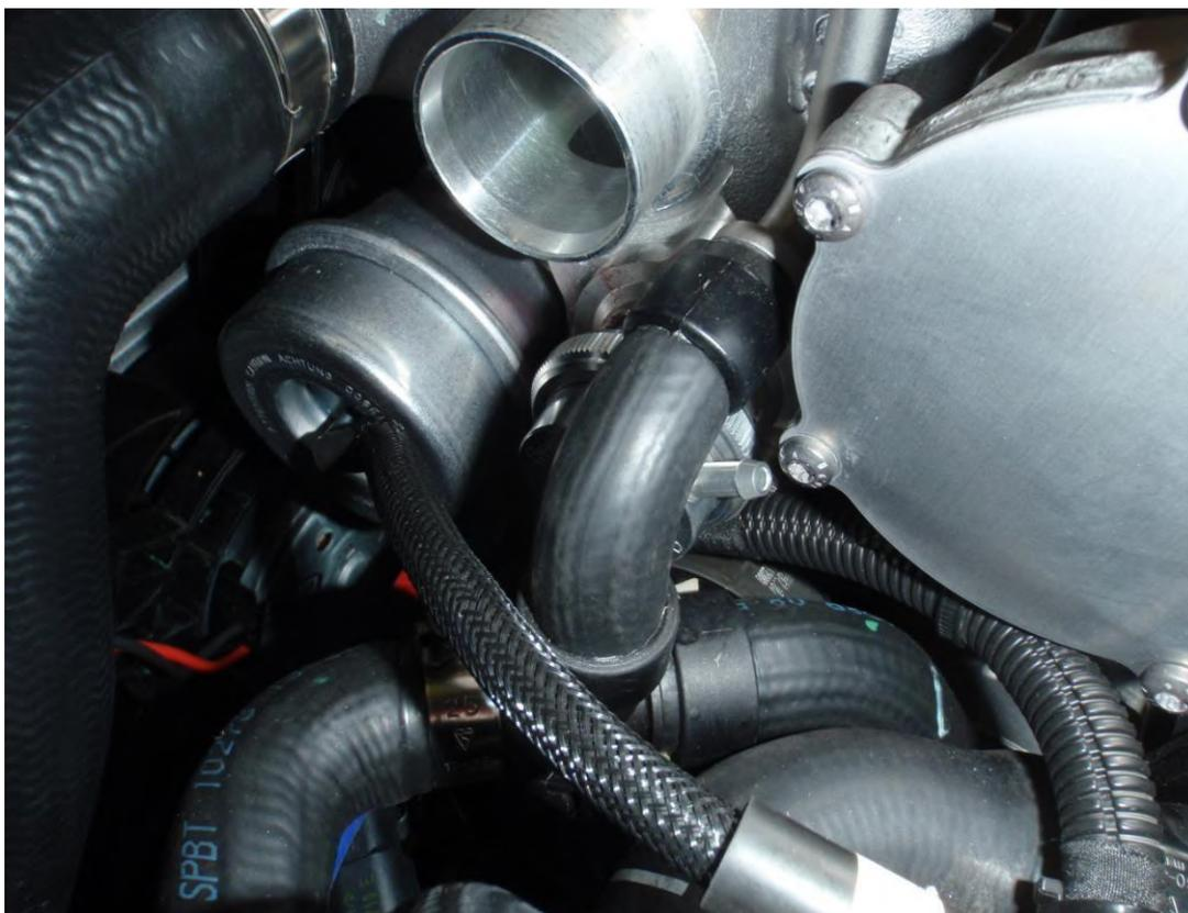
5. À l'aide d'une clé Allen de 3 mm, boulonnez le solénoïde au support à l'aide des boulons à clé Allen de 3 mm fournis, en vous assurant que l'orientation est la même que sur l'image ci-dessous.
