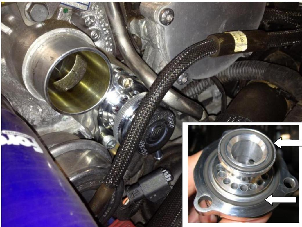
6. Localisez la pompe à vide à l'extrémité de la tête (juste derrière la vanne) et retirez le tuyau à vide illustré ci-dessous. Coupez ensuite une courte longueur (50 mm) du tuyau d'aspiration en silicone fourni et poussez-le sur la sortie de la pompe. Utilisez le t fourni pour joindre le nouveau tuyau en silicone à l'ancien tuyau d'aspiration et pointez le té vers l'avant dans le compartiment moteur.
