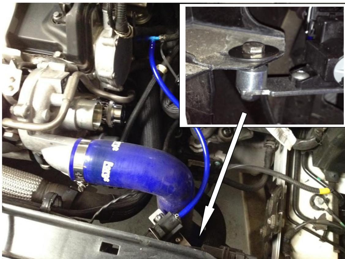
9. Connectez un tuyau d'aspiration au port INFÉRIEUR de la soupape de décharge. Vous trouverez peut-être plus facile de dévisser et de retirer le haut de la valve pour ce faire. Si vous le faites, assurez-vous d'attraper le ressort lorsque vous dévissez le haut. Acheminez ce tuyau d'aspiration vers le port REAR METAL sur le solénoïde, coupez le tuyau à la longueur et ajustez-le.
